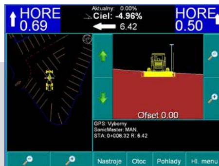
Konfigurovateľné zobrazenie polohy stroja voči projektu
